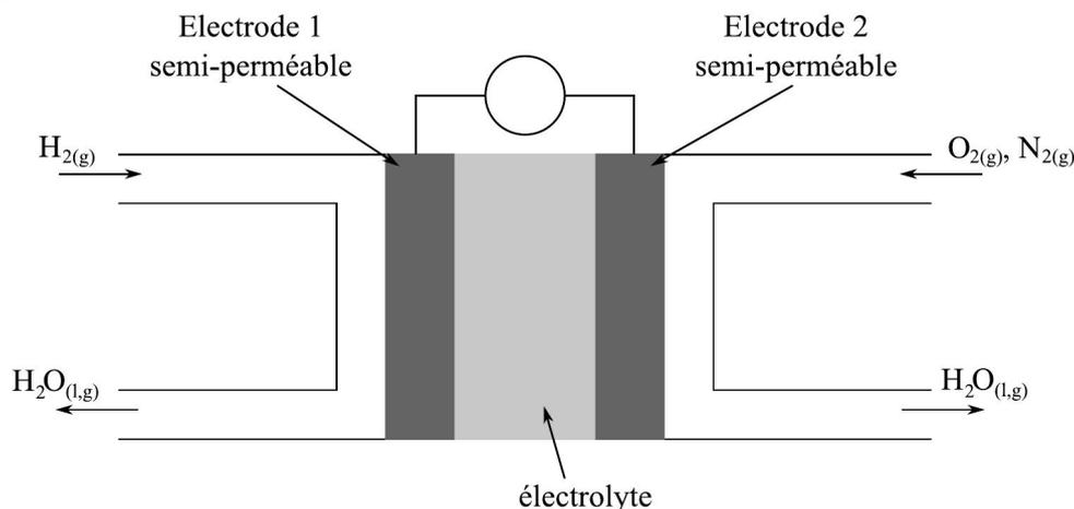
Chaque cellule élémentaire est constituée de deux compartiments disjoints alimentés chacun en gaz dihydrogène et dioxygène. Les électrodes sont séparées par un électrolyte solide qui laisse passer les anions oxygène.
