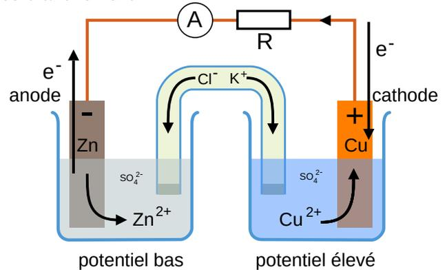
On constate au bout d'un moment que la plaque de zinc est attaquée, et qu'il y a un dépôt supplémentaire de cuivre sur la plaque de cuivre.
