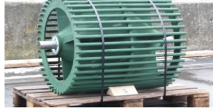
Les moteurs asynchrones sont les plus largement utilisés, grâce à leur rapport coût/puissance le plus faible et des rendements très proches de 1 rendus possibles par l'absence de balais (le rotor n'étant relié à rien électriquement). Cette absence de balais réduit considérablement l'usure et l'entretien. Un des inconvénient est une vitesse de rotation pas nécessairement très précise.
