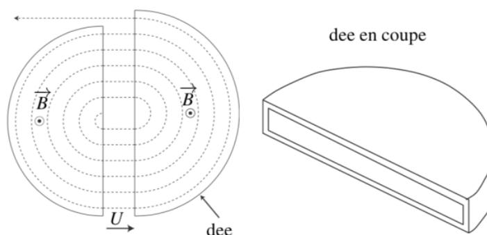
La valeur du champ magnétique dans les dees est  $B = 0,1 \text{ T}$ . L'amplitude de la tension crête à crête générant le champ électrostatique entre les dees est  $U_m = 2,5 \cdot 10^3 \text{ V}$ . Les particules accélérées sont des protons (masse  $m_p = 1,67 \times 10^{-27} \text{ kg}$ , charge  $e = 1,602 \times 10^{-19} \text{ C}$ ).
