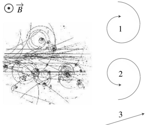
La photographie ci-contre représente un cliché typique des traces observées lors d'une collision à haute énergie de particules au CERN. Sur le côté droit, on a schématisé les trois types de trajectoires observées avec leur sens de parcours.
