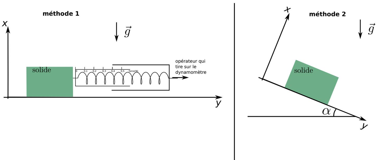
**Méthode 1 :** Le plan de travail est horizontal. On tire sur l'objet à l'aide d'un dynamomètre, jusqu'à ce que l'objet soit entraîné. Au moment où il est entraîné, on note la valeur de la force  $F$  lue sur le dynamomètre.
