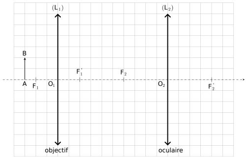
On s'intéresse à l'oculaire seul. L'indication 10x donne la valeur du grossissement commercial  $G_2 = \alpha'/\alpha_{\rm max}$ , où :  $\alpha'$  est l'angle sous lequel est vue l'image d'un objet placé dans le plan focal objet de l'oculaire ;  $\alpha_{\rm max}$  est l'angle sous lequel est vu ce même objet à l'œil nu à une distance minimale de  $25\,\rm cm$ . B Ces deux situations sont schématisées ci-contre.
