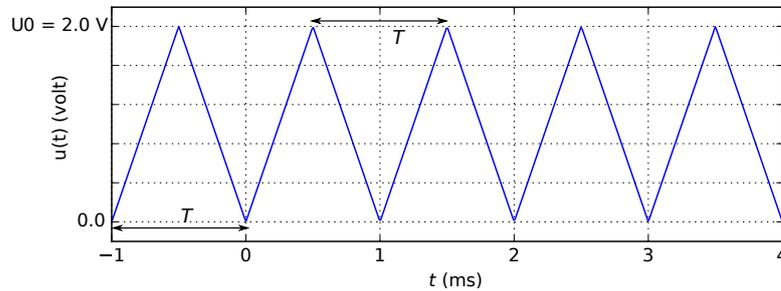
2 - La fréquence est  $f = \frac{1}{T} = 1,0 \times 10^3 \text{ Hz} = 1,0 \text{ kHz}$ .
