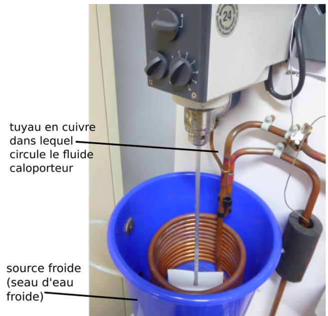
On note  $T_c(t)$  la température de la source chaude en fonction du temps  $t$ , et  $T_{c0} = T_c(0) = 25^\circ\text{C}$ . De même,  $T_f(t)$  est la température de la source froide, et  $T_{f0} = T_f(0) = 10^\circ\text{C}$ . Chaque seau contient  $m = 4\text{ kg}$  d'eau, de capacité thermique massique  $c = 4.2 \times 10^3\text{ kJ} \cdot \text{kg}^{-1} \cdot \text{K}^{-1}$ .
