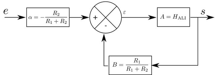
(Pour une motivation de ceci, voir par exemple <http://www.bedwani.ch/electro/ch9/index.htm#A006>, sinon sur le cas présent on peut simplement constater que les fonctions de transfert  $s/e$  du circuit électrique de gauche et du schéma bloc de droite sont bien identiques.)
