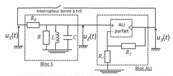
Montage envisagé pour extraire l'information issue d'un capteur. L'ALI utilisé, que l'on supposera parfait, est alimenté au moyen d'une alimentation symétrique  $\pm V_{CC}$ = $\pm 12V$  et sa tension de saturation est  $V_{SAT}$ = $\pm 11V$ .
