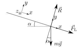
• Réaction du support  $\vec{R} = R\vec{e}_y$ .
