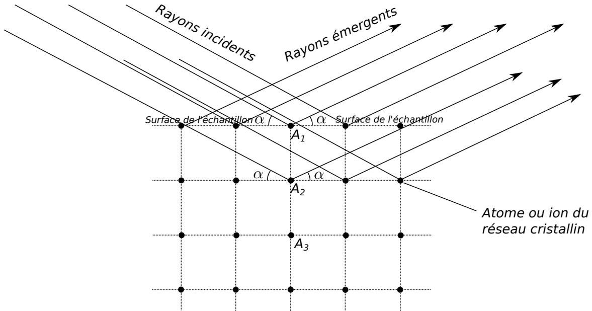
En sortie, tous les rayons lumineux interfèrent, et il s'agit de voir pour quels angles ces interférences sont constructives et maximales.
