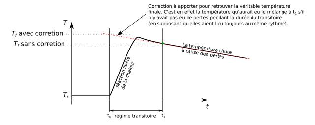
Le fait de suivre la température longtemps après la thermalisation du mélange permet d'estimer les pertes thermiques du calorimètre, et de les corriger.
