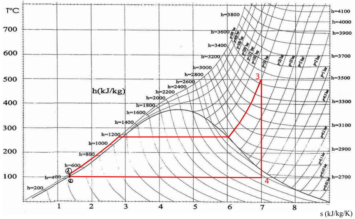
(doc. 2) Tracé du cycle sur le diagramme  $T$ - $s$ .
