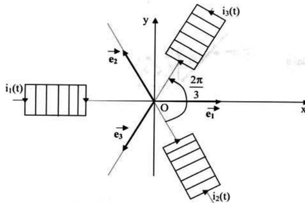
Figure 11 : bobinages statoriques
