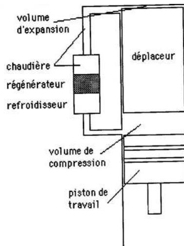
Figure 7 : schéma d'un moteur Stirling
