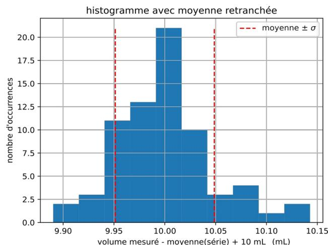
**Figure 3** - Distribution des volumes mesurés pour des pipettes de volume nominal  $V_0 = 10$  mL. L'histogramme est artificiellement centré sur 10 mL, car pour les volumes d'une série donnée (il y a 4 séries, pour une série donnée la balance et la pipette utilisées sont les mêmes), on leur retranche la moyenne de la série en question (cf annexe). Seul l'écart-type importe.
