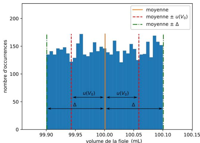
**Figure 2** - Distribution uniforme (simulée) des volumes de 5000 fioles jaugées de volume nominal  $V_0 = 100$  mL et de tolérance  $\Delta = 0,1$  mL. Ceci illustre la différence entre  $\Delta$  et  $u$ , avec ici  $u = \Delta/\sqrt{3}$  pour la distribution uniforme.
