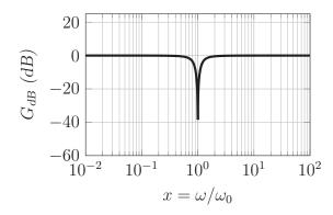
3 - \* Le condensateur et la bobine sont en parallèles et sont équivalents à une impédance  $\underline{Z}_{\acute{e}a}$  donnée par
