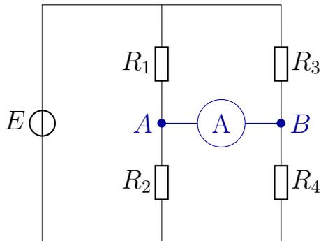
On considère le circuit ci-contre, appelé pont de Wheatston. On va voir qu'il permet de réaliser des mesures de résistances assez précises.
