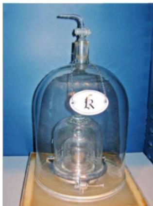
1 kg, c'est exactement la masse de ce cylindre de platine 😎
