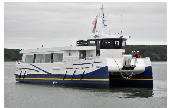
Bateau dont les batteries sont des super-condensateurs.
