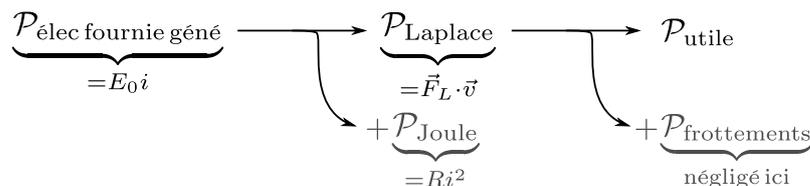
► **Égalité entre puissance des forces de Laplace et puissance de la fem induite :**
