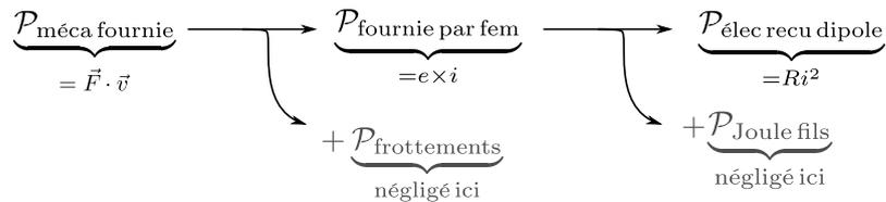
▶ **Égalité entre puissance des forces de Laplace et puissance de la fem induite :**
