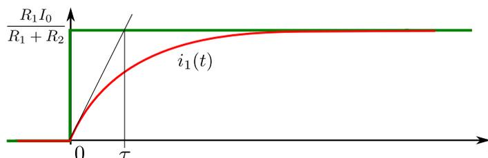
Correction – DM – Charge d'une bobine en dérivation
