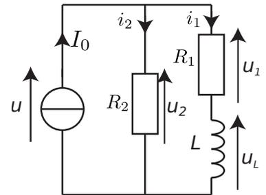
On remarque que  $i_2(t)$  n'est pas continue en  $t = 0$  (il passe de 0 à  $I_0$ ). Rien d'étonnant, il ne s'agit pas du courant traversant une bobine, il peut donc être continu ou non.
