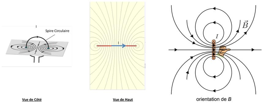
► **Bobine** : c'est un enroulement de fil parcouru par un courant  $I$ .
