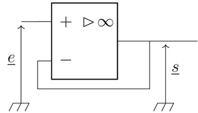
8 - Réaliser la mise en cascade des deux filtres, en intercalant entre les deux un suiveur (éteindre le GBF et m'appeler **avant** de le remettre en marche).
