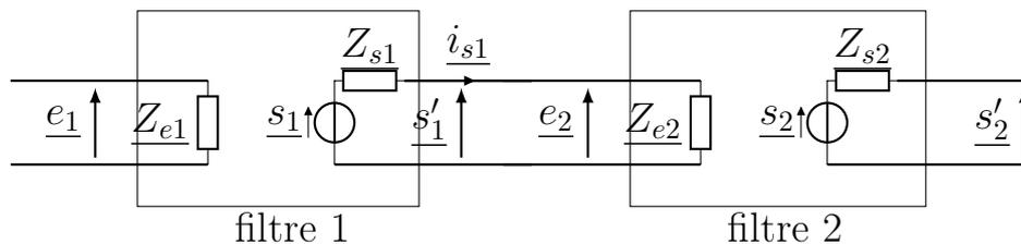
Pour que le courant intermédiaire  $\underline{i}_{s1}$  soit quasiment nul, et donc que le filtre 1 soit bien en sortie ouverte, il faut que  $\underline{Z}_{e2}$  soit très grande. Devant quoi? On admet qu'il faut que  $\underline{Z}_{e2} \gg \underline{Z}_{s1}$ .
