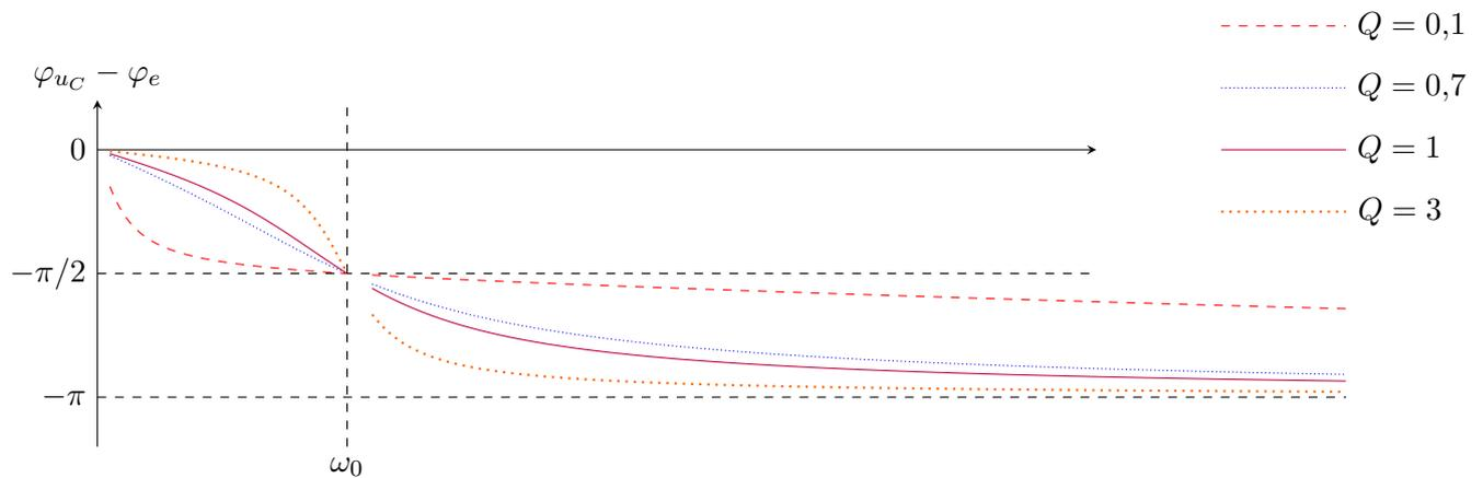
5 - On a montré que la pulsation de résonance est  $\omega_r = \omega_0 \sqrt{1 - \frac{1}{2Q^2}} < \omega_0$ .
