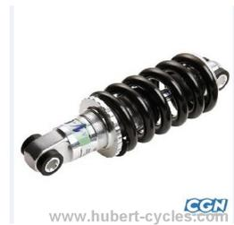
On considère la suspension avant d'un VTT, que l'on modélise comme l'association d'un ressort de raideur  $k$ , longueur à vide  $l_0$ , en parallèle avec un amortisseur de constante de frottement  $\alpha$ . La raideur  $k$  et le coefficient  $\alpha$  peuvent être réglés par l'intermédiaire de la pression en huile et en air dans la suspension. La roue suit exactement les oscillations du sol.
