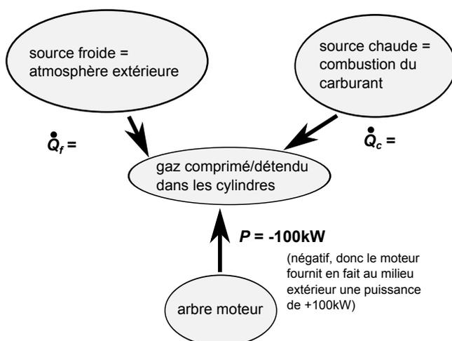
**Fonctionnement réel, avec  $S_c > 0$  - rendement = 0.3**
