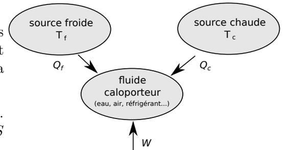
Ceci montre qu'il n'existe pas de machine thermique motrice (où on aurait  $W < 0$ ) monotherme. Il faut au minimum deux sources, une de température élevée pour fournir l'énergie thermique, et une de température plus basse qui récupère une partie de l'énergie thermique (celle qui n'a pas été convertie en travail).
