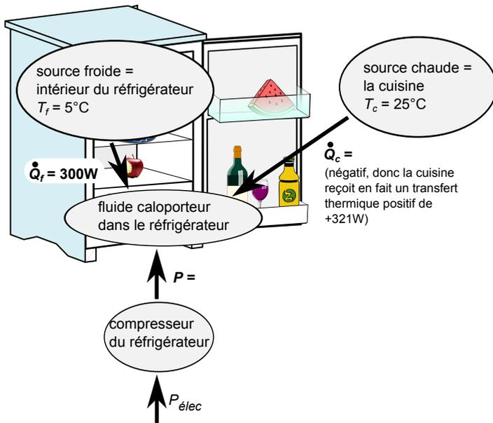
**Fonctionnement réel, avec  $S_c > 0$  -  $e_{réel} = 1.5$**
