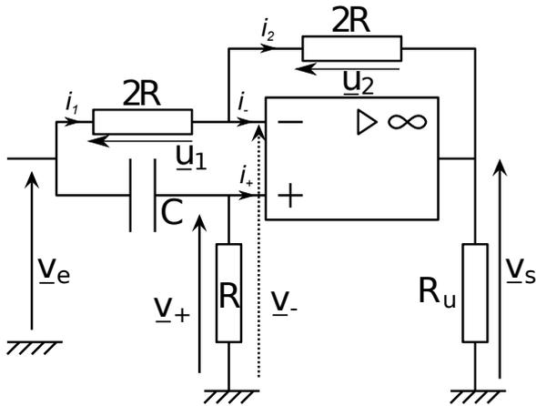
Première étape : on note les tensions et courants pertinents sur le schéma.
