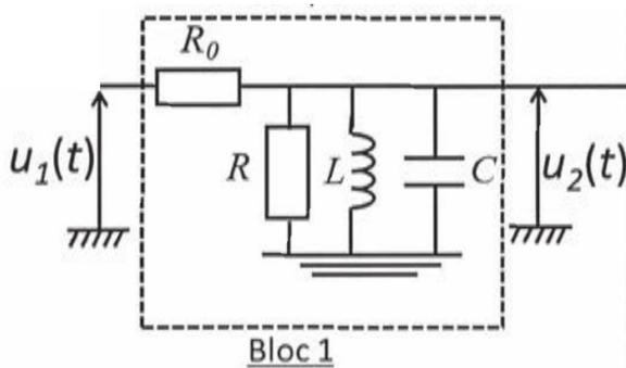
Le bloc 1 réalise un filtre de fonction de transfert complexe  $\underline{H} = \underline{u}_2/\underline{u}_1$ ,
