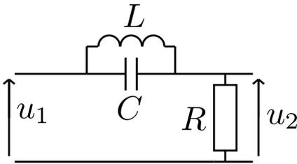
Le filtre ci-contre réalise la fonction de transfert complexe  $\underline{H} = \underline{u}_2/\underline{u}_1$ , avec
