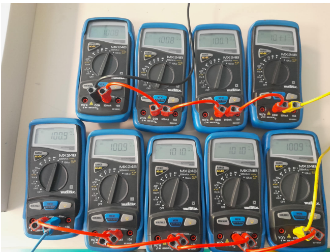
FIGURE 7 – Gauche : ces ampermètres en série indiquent entre 100,7 mA et 101,1 mA, ce qui est compatible avec les écarts déduits de la notice ( \Delta_{\text{notice}} = 0,3 \% + 2d = 0,5 \text{ mA} et les valeurs affichées sont dans une plage de 2\Delta ). Ainsi, si on dispose d'un seul amperemètre, on lit la valeur de I et on utilise u(I) = \Delta_{\text{notice}}/2 = 0,25 \text{ mA} , ce qui donne bien une bonne estimation. Droite : ces pressiomètres indiquent entre 990 hPa et 1009 hPa, ce qui est compatible avec les écarts notice ( \Delta_{\text{notice}} = 2 \% \times 1000 = 20 \text{ hPa} ), sauf pour l'appareil qui indique 1117 hPa et qui doit être ré-étalonné. Si on dispose d'un seul appareil, on lit la valeur de p et on utilise u(p) = \Delta_{\text{notice}}/2 , ce qui donne une bonne estimation (sauf pour celui qui est défectueux !). Autres exemples : balances figure 1 (les écarts sont anormaux), voltmètres figure 2 (écarts normaux).
