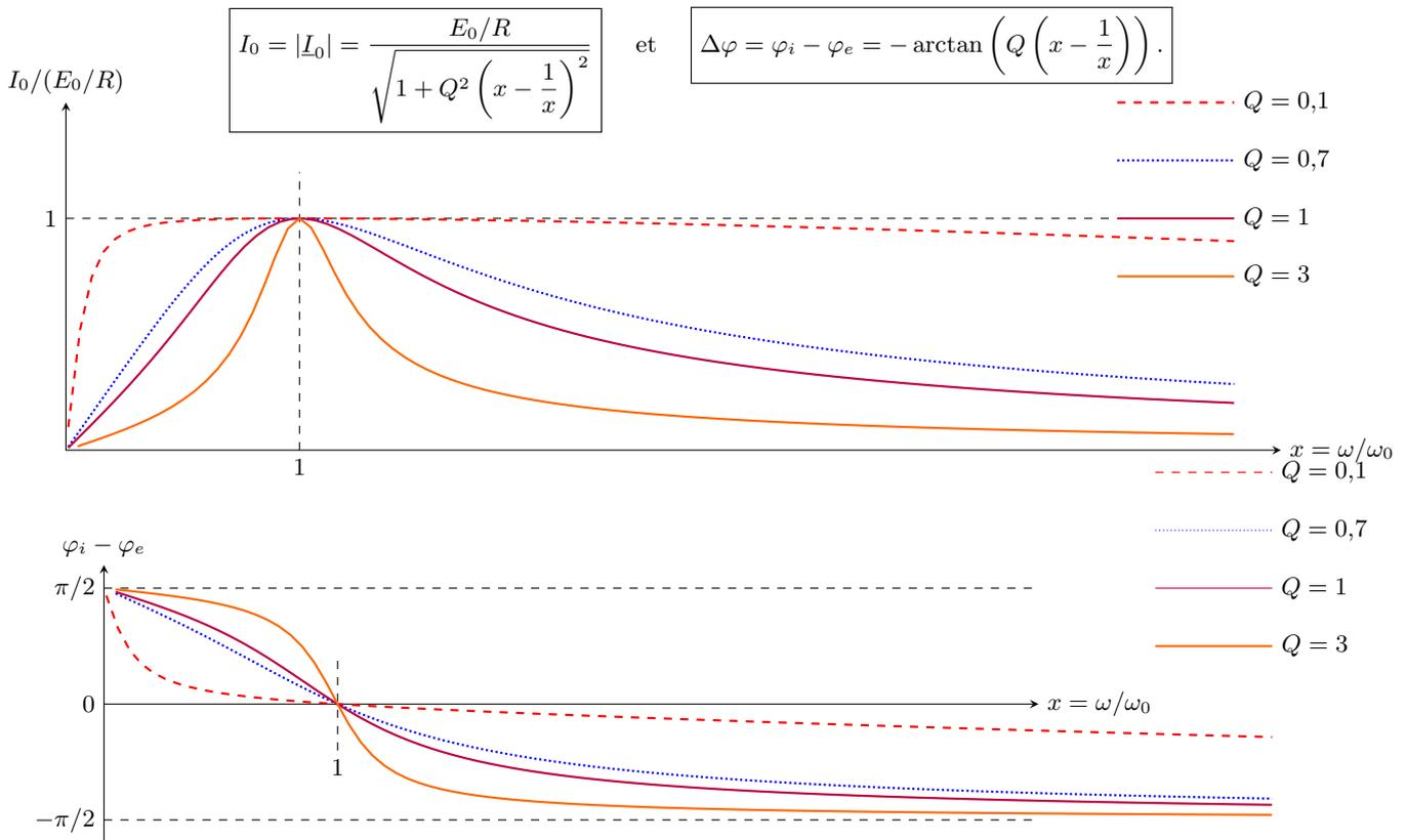
La résonance a lieu si  $I_0$  est maximal, donc en  $x = 1$ , donc pour  $\omega = \omega_0$ .
