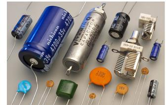
Si on impose une tension  $U$  entre les plaques, il y a accumulation d'une charge électrique  $+q$  sur une des armatures, et  $-q$  sur l'autre, afin de compenser cette différence de potentiel.
