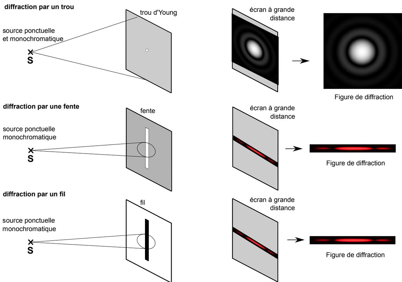
1 - Vous disposez de plusieurs fentes dont la taille  $d$  est connue. Utiliser une de ces fentes pour réaliser un montage, qui permet d'observer le phénomène de diffraction comme sur les schémas ci-dessus.
