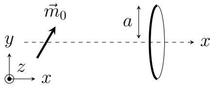
Un aimant de moment magnétique  $\vec{m}_0$  est placé dans le plan  $(Oxy)$ . Un système mécanique le met en rotation à vitesse angulaire  $\omega$  constante autour de l'axe  $(Oz)$ . Une spire circulaire de rayon  $a$  et de résistance  $R$  est placée sur l'axe  $(Ox)$  à distance  $x \gg a$ . On négligera l'inductance propre de la spire.
