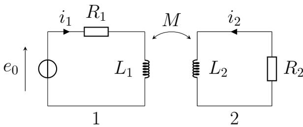
Pour modéliser ceci, nous considérons que l'objet métallique agit comme un circuit d'inductance propre  $L_2$ , de résistance totale  $R_2$ , et nous notons  $M$  le coefficient d'inductance mutuelle entre l'objet et le détecteur.
