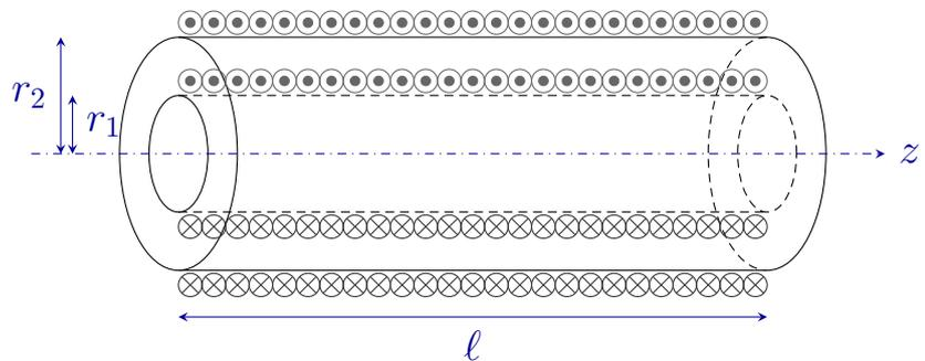
1 - Déterminer les coefficients d'induction propre  $L_1$ ,  $L_2$ , et le coefficient d'induction mutuelle  $M$ .
