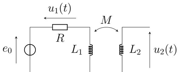
Le montage ci-contre permet de mesurer le coefficient d'inductance mutuelle entre deux circuits, représentés ici par deux bobines. Les deux bobines se font face comme sur la figure.
