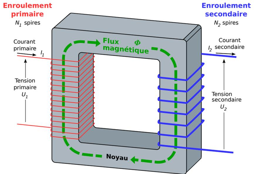
1 - Exprimer le flux du champ magnétique à travers le circuit 1 en fonction de  $\Phi$  et de  $N_1$ . On prendra garde au fait que ce flux est à travers la normale au circuit 1, dont le sens est donné en fonction du courant par la règle de la main droite.
