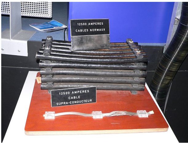
Câbles électriques utilisés par le CERN, de type normal en haut et de type supraconducteur en bas, prévus pour transporter le même courant de 12 500 A. (source : Wikipedia)
