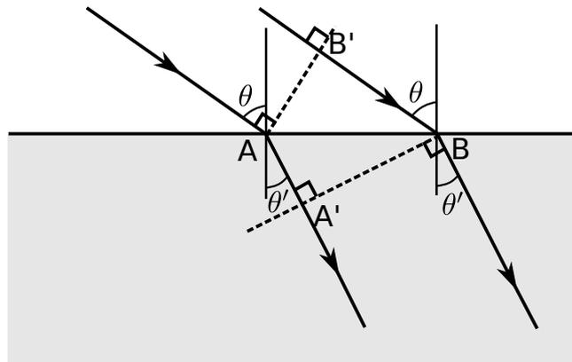
2 - \* Par définition, deux points sur une même surface d'onde ont la même phase. Donc ici on a  $\varphi(A, t) = \varphi(B', t)$  et  $\varphi(A', t) = \varphi(B, t)$ .
